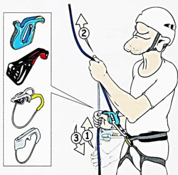
Abb. 4 Seilausgeben und -einnehmen bei Ergo, MegaJul, Jul² und Smart.
