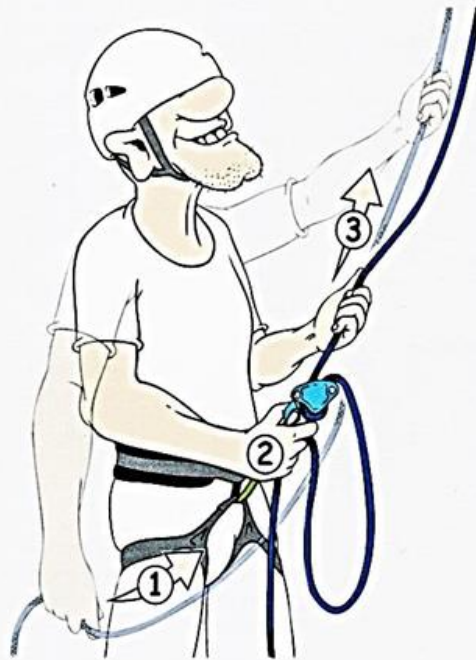
Abb. 3 „Pistolengriff“ zum schnellen Seilausgeben beim Matik.
