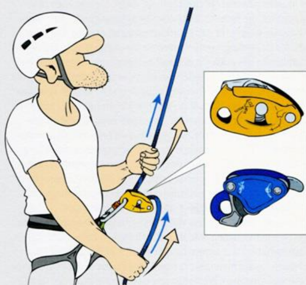
Abb. 1 „Tubehandhabung“ beim Grigri und beim Matik. Die sicherste Bedienmethode, so lange der Seildurchmesser es zulässt.
