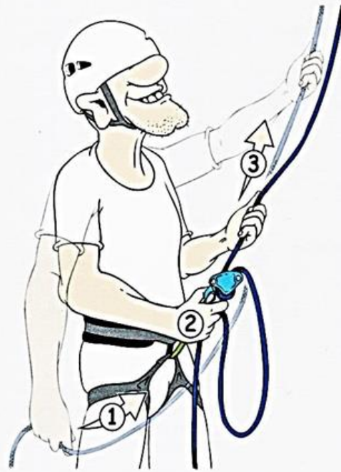
Abb. 3 „Pistolengriff“ zum schnellen Seilausgeben beim Matik.
