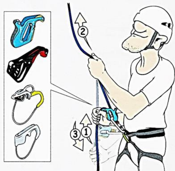
Abb. 4 Seilausgeben und -einnehmen bei Ergo, MegaJul, Jul 2 und Smart.
